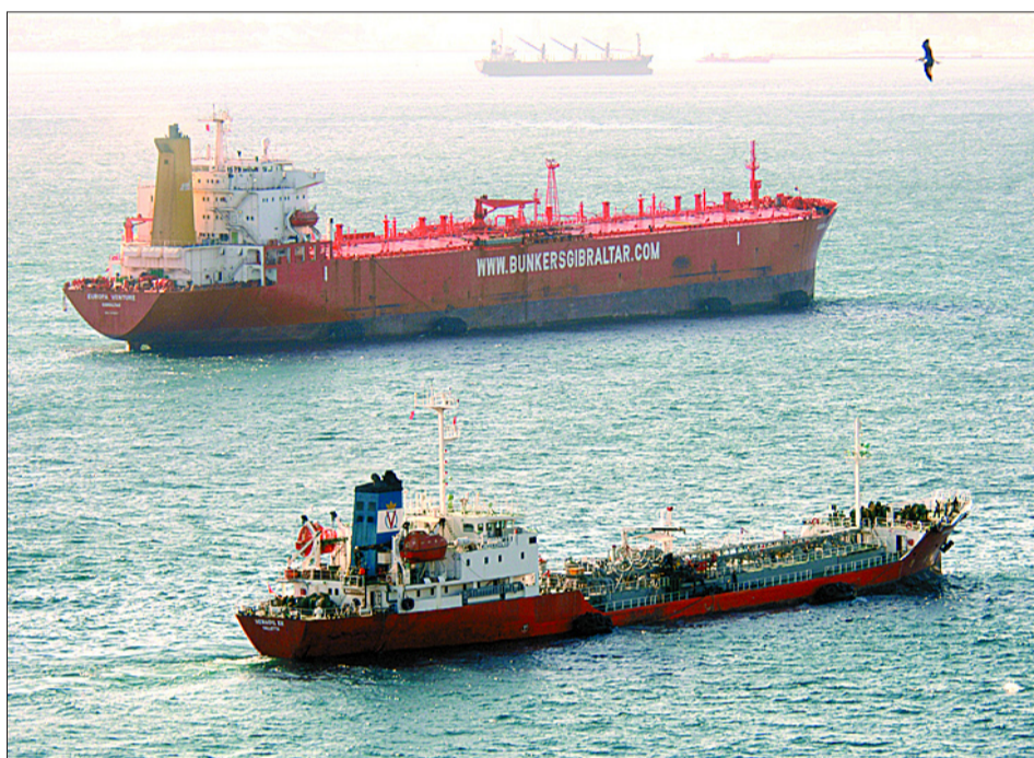
La gasolinera flotante Europa Venture , de Bunker Gibraltar, no tiene doble casco. DM PARODY DOTCOM.GI
